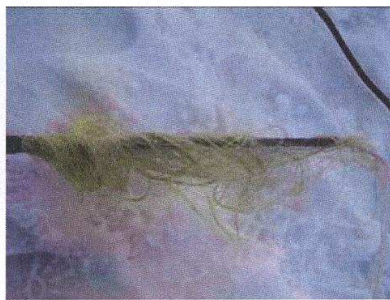
Рисунок 3. Характер разрушения кабеля в процессе испытаний.
