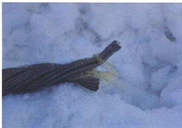
Рисунок 3. Характер разрушения кабеля в процессе испытаний.
