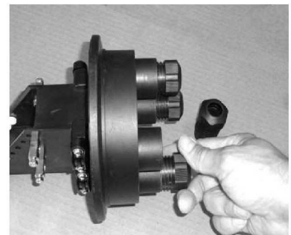
Герметизация кабельных вводов с помощью силиконовых втулок.
