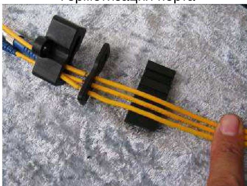
Герметизация порта вывода линий конечного потребителя
