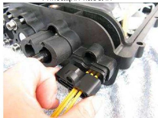
Герметизация порта вывода линий конечного потребителя
