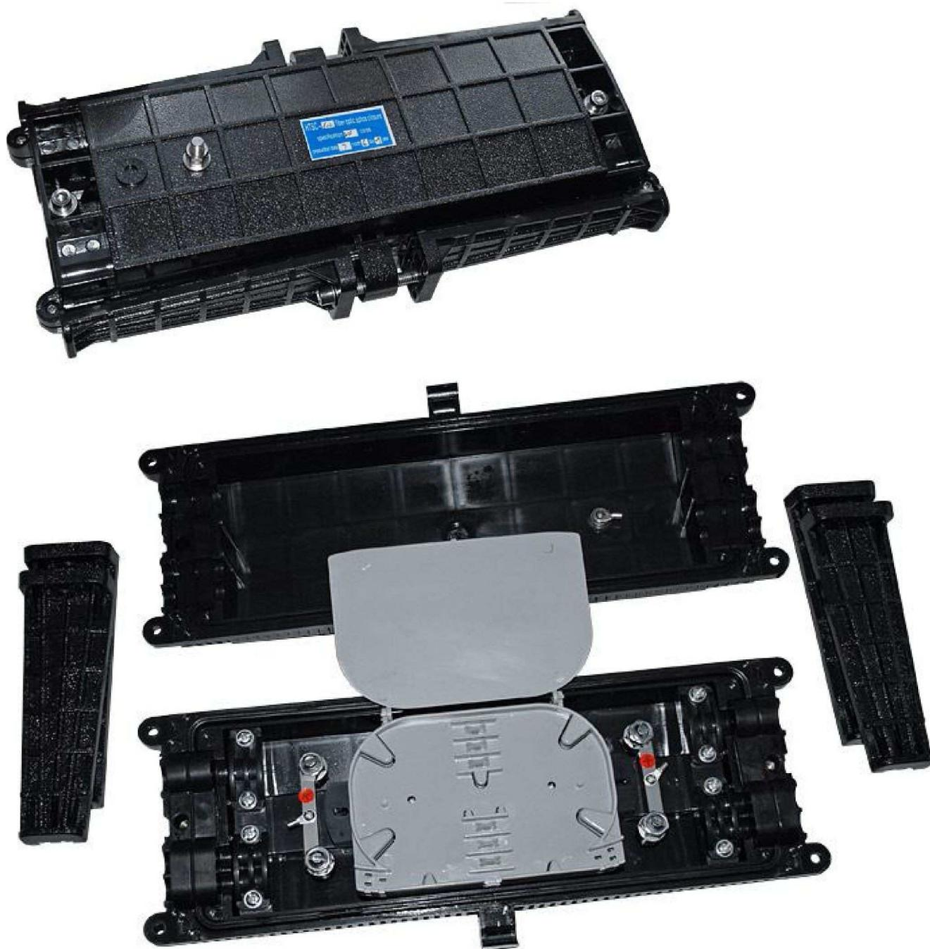
Многофункциональная проходная оптическая муфта. Применяется для сращивания оптических кабелей и защиты мест сварки оптических волокон. Может использоваться для воздушных линий, закладки в землю, установки в кабельной канализации.
